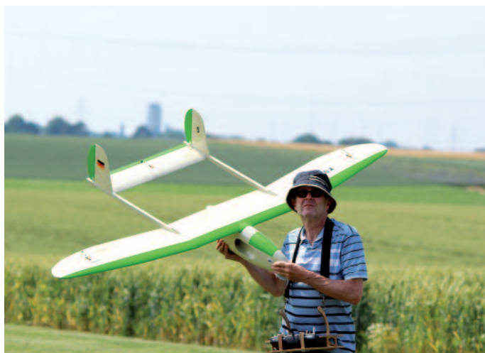
Karl Heinz Butz hat seine Komet 2 mit einem WeMoTec Mini-Impeller ausgestattet.
